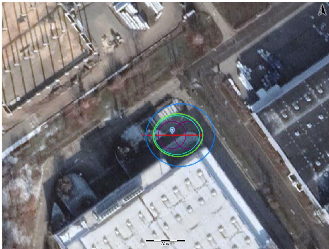
10. ábra - A DMC és EMC (külső) tartályok kármentőjében keletkező tócsatűz hőhatása
