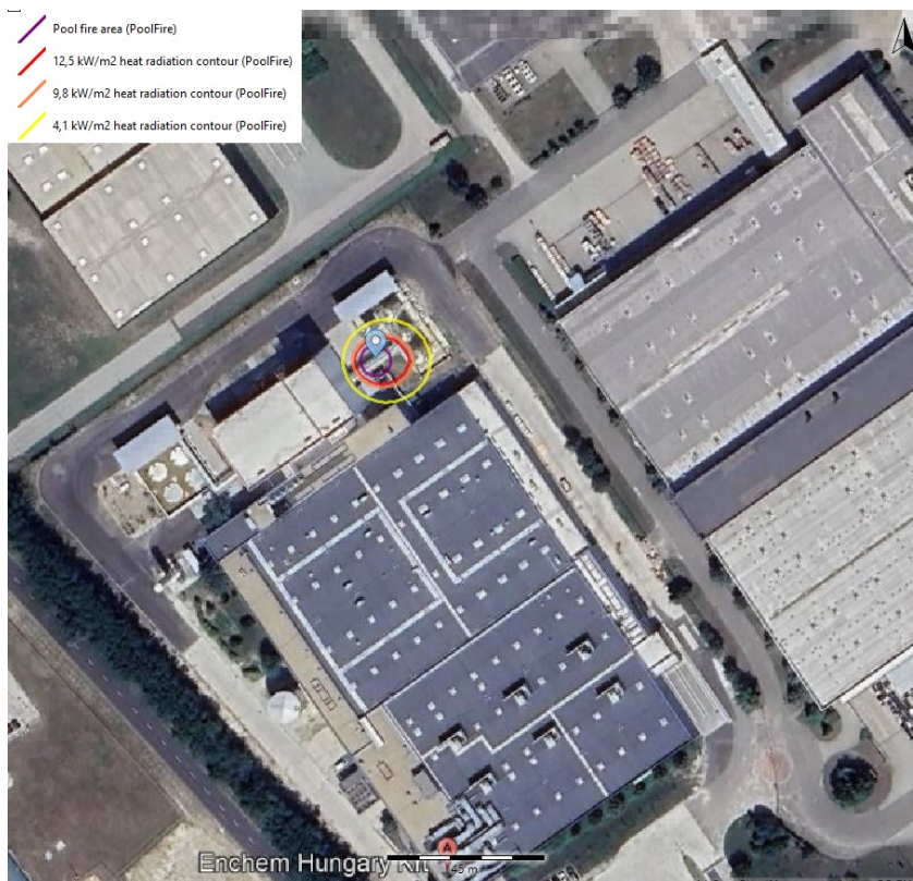
13. ábra: Veszélyes anyagot tartalmazó csővezeték- Tócsatűz
