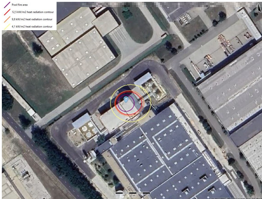
18. ábra – A LiPF6 oldat belső tartályok kármentőjében keletkező tócsatűz hőhatása
