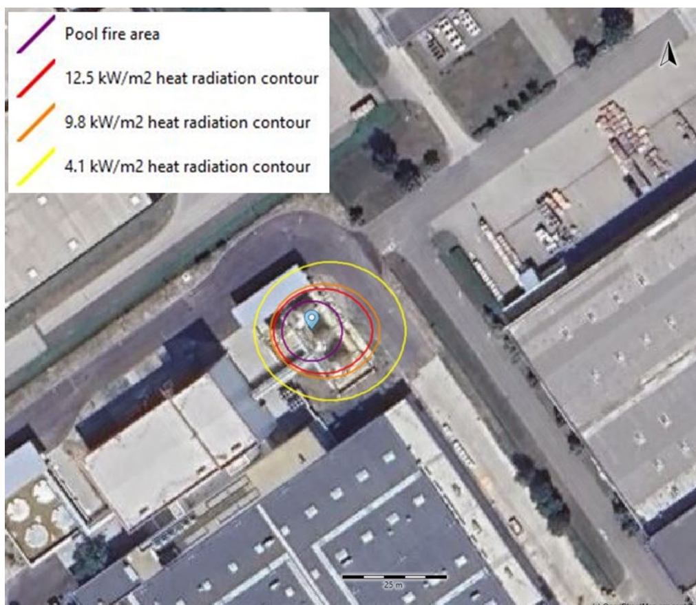
10. ábra - A külső tartályok kármentőjében keletkező tócsatűz hőhatása
