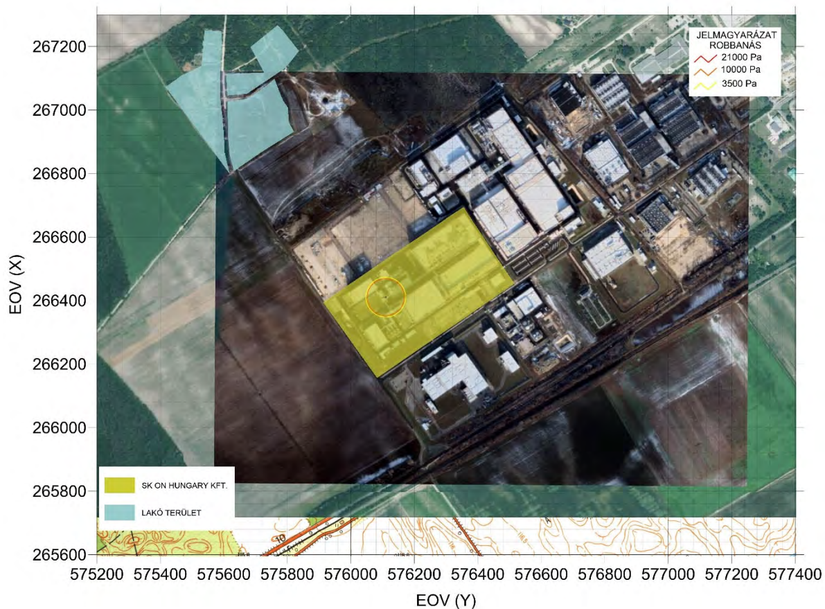
Az FGR_2.1.1_B következmény robbanás esetén
